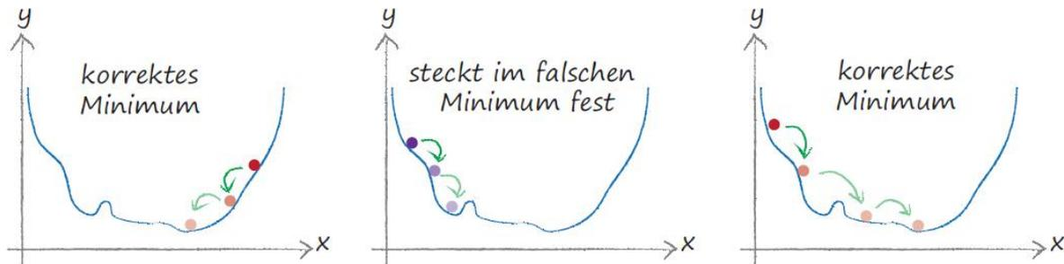
Abbildung 1-82: Verschiedene Ausgangspunkte beim Gradientenverfahren
