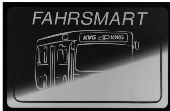
Abb. 13.9 Fahrsmart II – kontaktlose Chipkarte, zur Hälfte geöffnet. Am rechten unteren Bildrand ist deutlich die Spule des Transponders zu erkennen. (Foto: Giesecke & Devrient, München)
