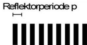
Abb. 4.96 Geometrie eines einfachen Reflektors für Oberflächenwellen.
