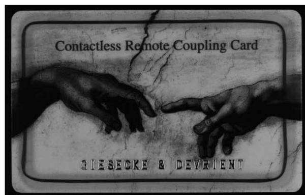
Abb. 2.12 Halbtransparente kontaktlose Chipkarte. Deutlich zu erkennen die Transponderantenne entlang des Kartenrandes. (Foto: Giesecke & Devrient, München)
