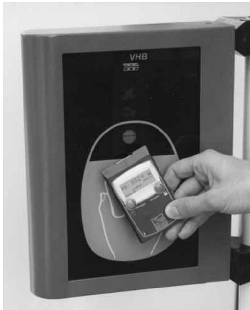
Abb. 13.11 Kontaktlose Transaktion mit dem FlexPass an einem Lesegerät.
