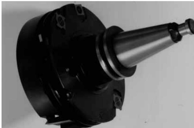
Abb. 13.48 CNC-Fräswerkzeug mit Transponder im Anzugsbolzen. (Foto: Leitz GmbH & Co., Oberkochen)
