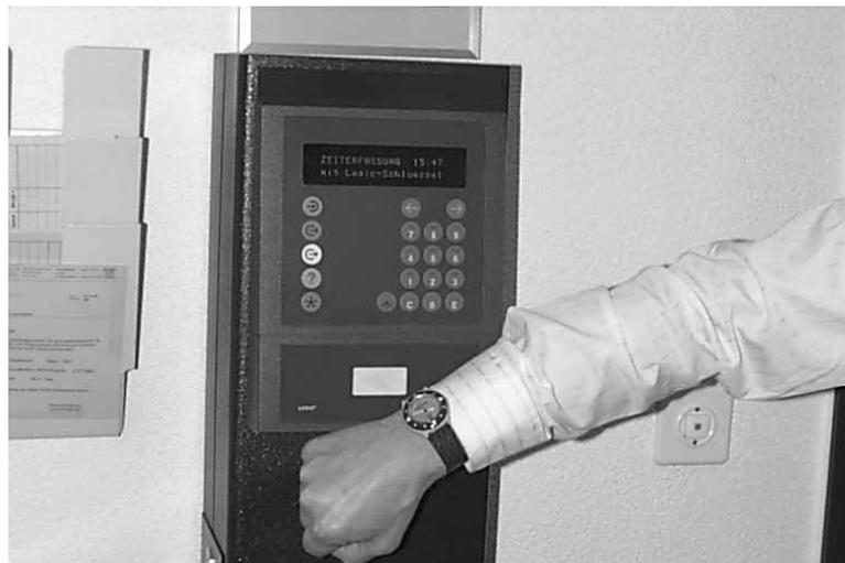
Abb. 13.18 Zutrittskontrolle und Zeiterfassung in einem Terminal kombiniert. Als kontaktloser Datenträger dient die Uhr mit integriertem Transponder.
