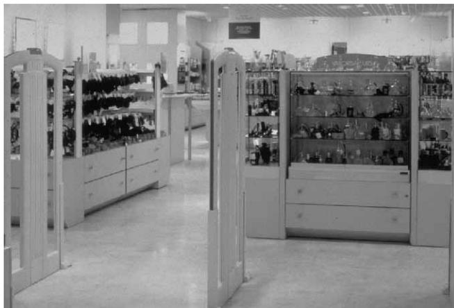
Abb. 9.41 Warensicherungssystem im praktischen Einsatz.
