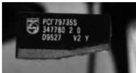
Abb. 2.5 Transponder im Plastikgehäuse. (Foto: Philips Semiconductors, Hamburg)
