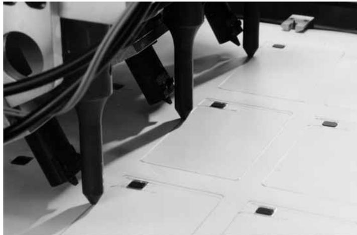
Abb. 12.7 Herstellung einer Chipkartenspule durch Verlegetechnik auf einer Inletfolie. Auf der Abbildung erkennbar: die Sonotroden sowie die Schweißelektroden (links neben den Sonotroden) zur Kontaktierung der Spulen, sowie einige fertiggestellte Transponderspulen.
