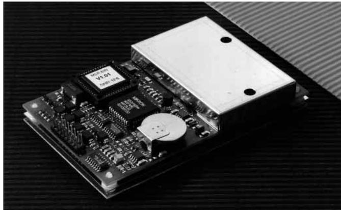
Abb. 11.3 Beispiel für ein Lesegerät. Die beiden Funktionsblöcke HF-Interface und Steuerung sind gut zu unterscheiden. (Foto: MIFARE®-Lesegerät, Philips Semiconductors Gratkorn, A-Gratkorn)
