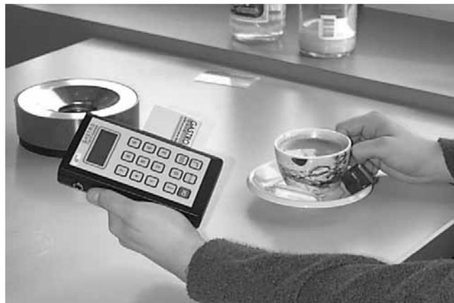
Abb. 11.24 Lesegerät für den portablen Einsatz im Zahlungsverkehr oder für Servicezwecke.
