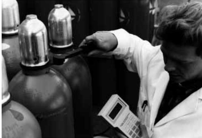
Abb. 13.40 Identifikation von Gasflaschen mit einem portablen Lesegerät. Das Lesegerät (scemtec SIH3) ist zum Betrieb mit Transpondern verschiedener Hersteller ausgelegt. (Foto: Philips Semiconductors Gratkorn, A-Gratkorn)
