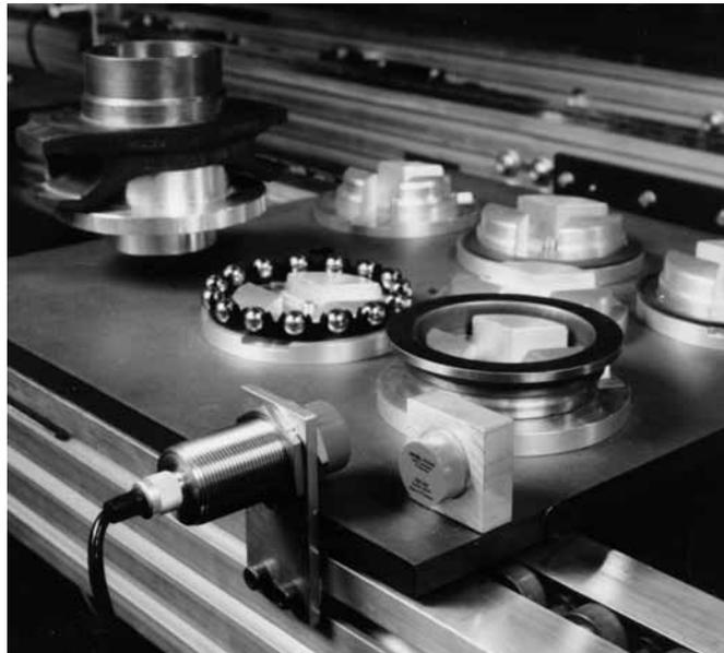
Abb. 13.54 Einzelteile eines Kupplungsaustrücklagers auf einer Umlaufpalette. Transponder und Leseantenne sind im Bild unten zu erkennen. (Foto: Pepperl & Fuchs, Mannheim)
