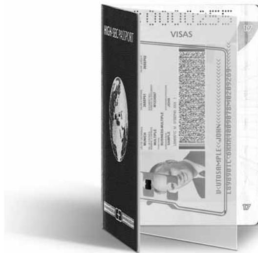
Abb. 13.12 Lage und Bauform der RFID-Antenne in einem ePass. Der Mikroprozessorchip ist als kleiner schwarzer Punkt über dem Passfoto zu erkennen.
