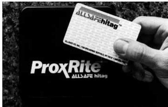
Abb. 1.7 RFID-Lesegerät und kontaktlose Chipkarte im praktischen Einsatz.
