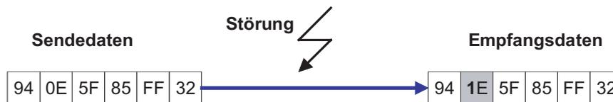
Abb. 7.1 Durch Störungen auf der Übertragungsstrecke können Fehler in den Daten hervorgerufen werden.
