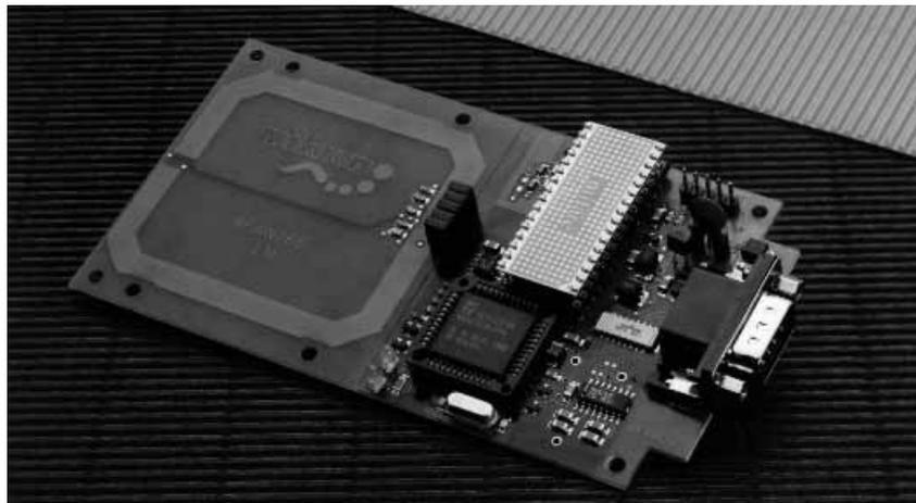
Abb. 11.19 Lesemodul mit integrierter Antenne und Anpassschaltung.
