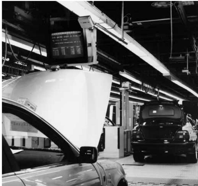
Abb. 13.53 Nach erfolgter Identifikation des Fahrzeugs werden dessen spezifische Daten abgerufen und angezeigt. (Foto: Pepperl & Fuchs, Mannheim)
