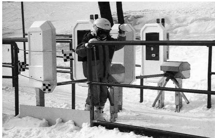
Abb. 13.16 Kontaktlose Lesegeräte als Zugangskontrolle und Kassiereinrichtung zu einem Skilift.
