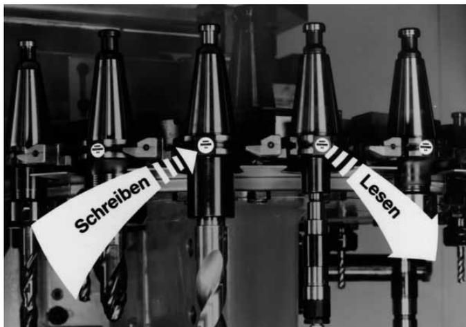
Abb. 13.49 Verschiedene Holzbearbeitungswerkzeuge mit Transponder-Datenträger im Steilkegelschaft. (Foto: EUCHNER + Co., Leinfelden-Echterdingen)
