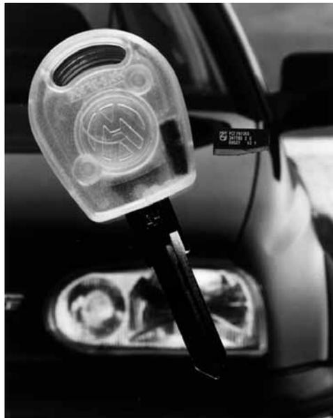
Abb. 13.36 Zündschlüssel mit integriertem Transponder. (Foto: Philips Semiconductors, Hamburg)
