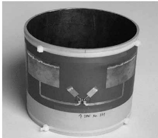
Abb. 10.39 Anordnung zum Messen der Temperatur und des Drehmoments einer Antriebswelle mit Oberflächenwellentranspondern. Auf der Abbildung ist die Antenne des Transponders für den Frequenzbereich 2,45 GHz erkennbar. (Foto: Siemens AG, ZT KM, München)
