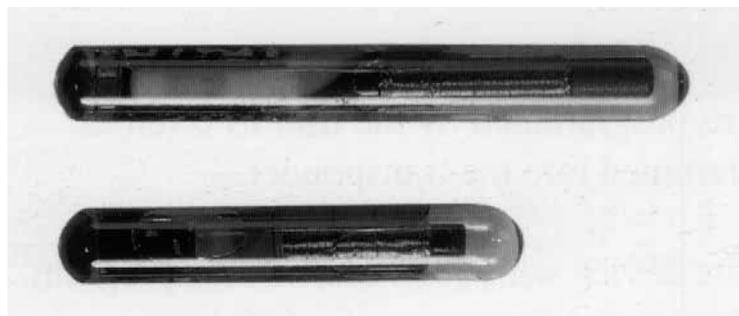
Abb. 13.27 Großaufnahme verschiedener Bauformen von Glastranspondern.
