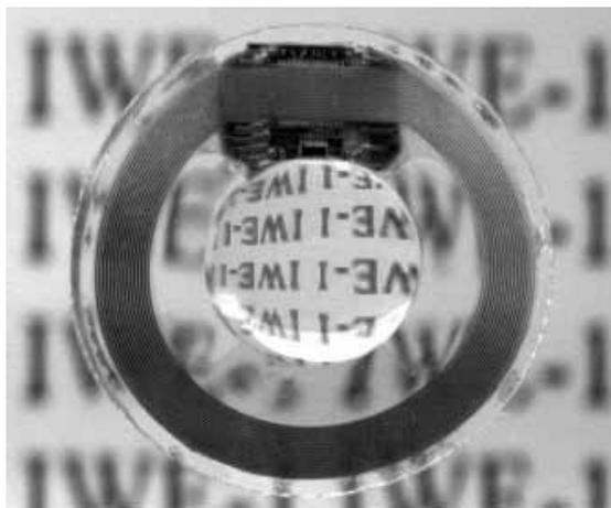
Abb. 13.55 Transpondereinheit nach dem Verguss in eine künstliche Linse aus Silikon.
